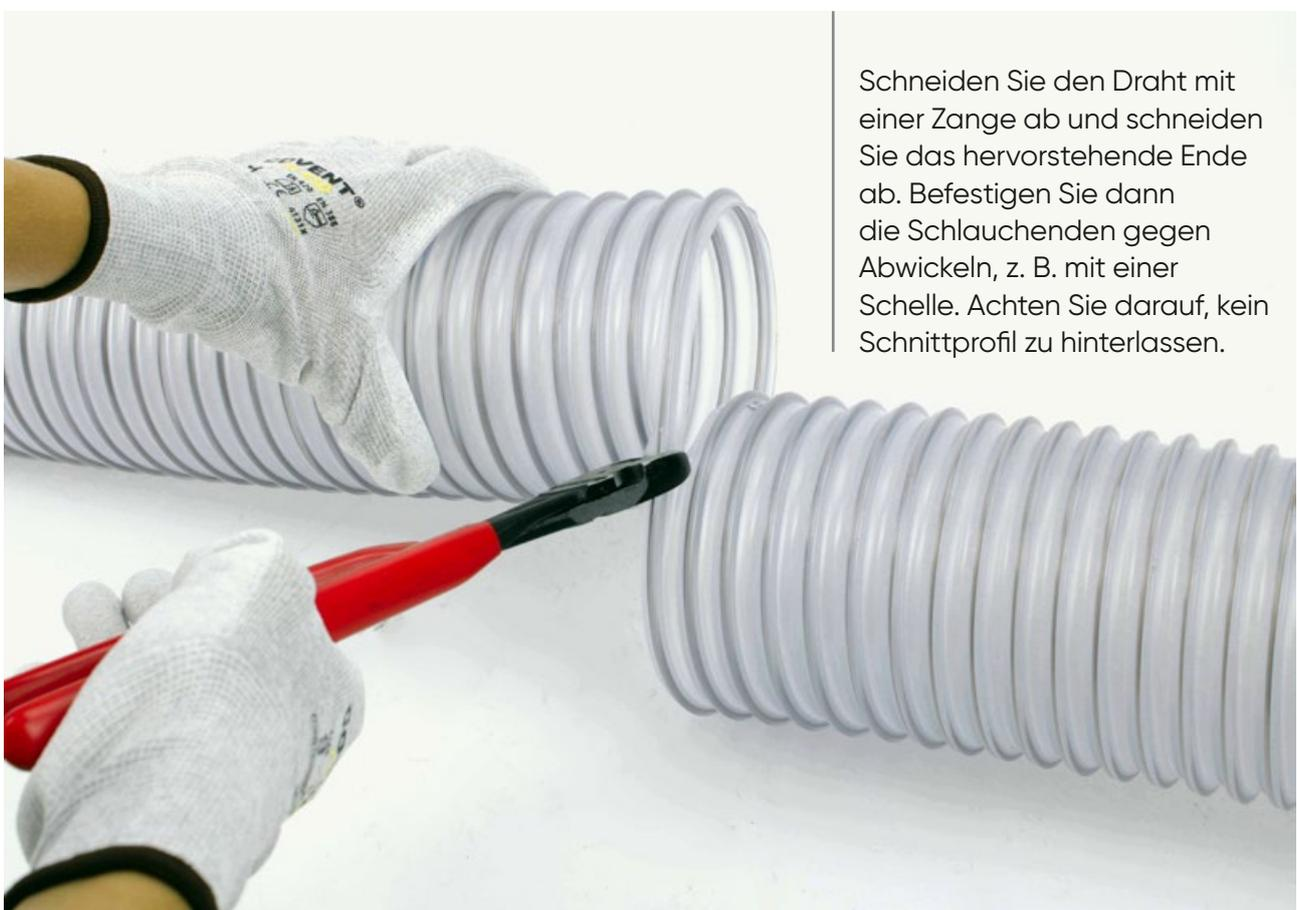
Schneiden Sie den Draht mit einer Zange ab und schneiden Sie das hervorstehende Ende ab. Befestigen Sie dann die Schlauchenden gegen Abwickeln, z. B. mit einer Schelle. Achten Sie darauf, kein Schnittprofil zu hinterlassen.
