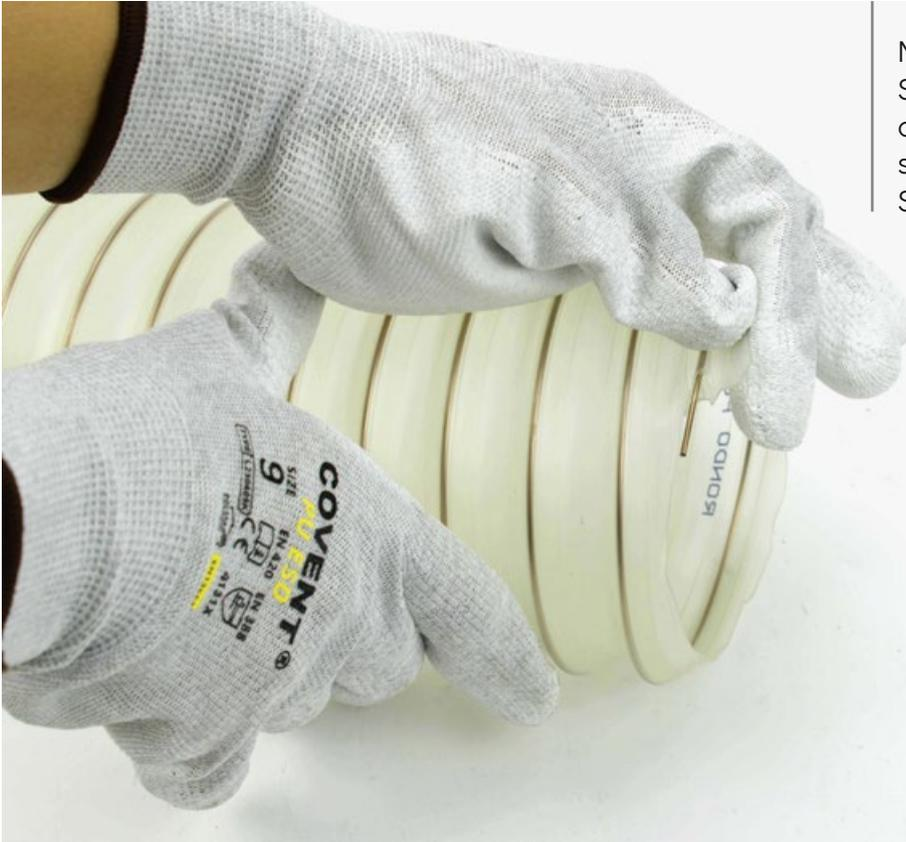
Mit einem Messer trennen Sie das Drahtende von der Schlauchwand und säubern Sie z.B. mit Sandpapier.
