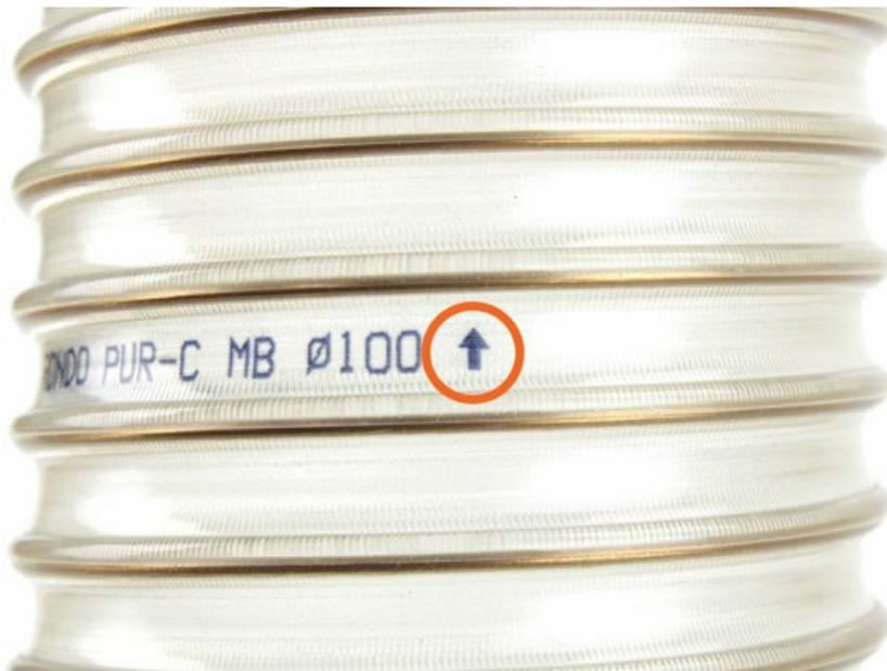
Schläuche sollten so montiert werden, dass die Richtung des Mediumflusses mit der auf dem Schlauch angegebenen Richtung übereinstimmt (gilt nicht für Keil- und Vakuumschläuche).
