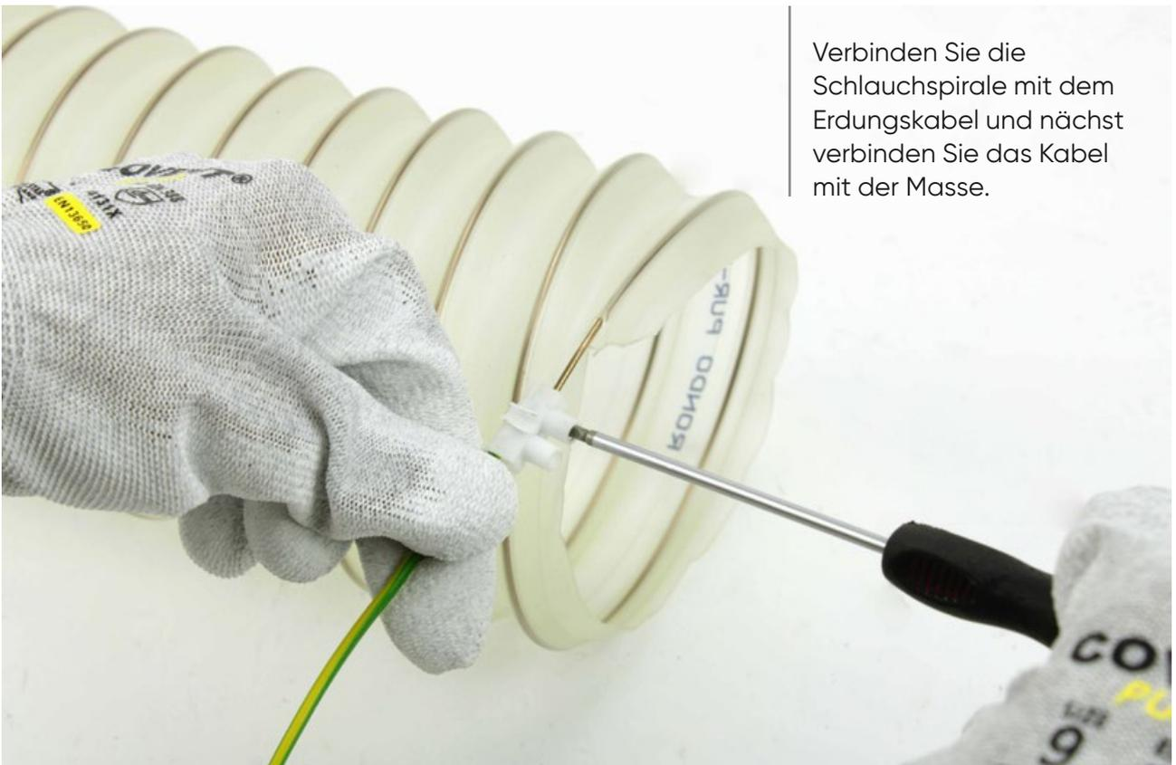
Verbinden Sie die Schlauchspirale mit dem Erdungskabel und nächst verbinden Sie das Kabel mit der Masse.
