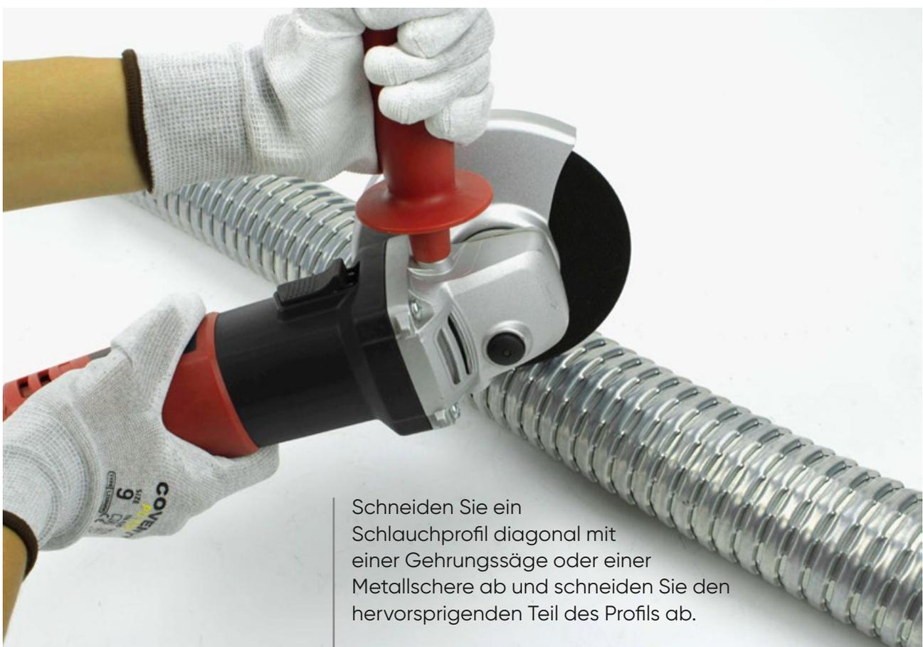
Schneiden Sie ein Schlauchprofil diagonal mit einer Gehrungssäge oder einer Metallschere ab und schneiden Sie den hervorspringenden Teil des Profils ab.
