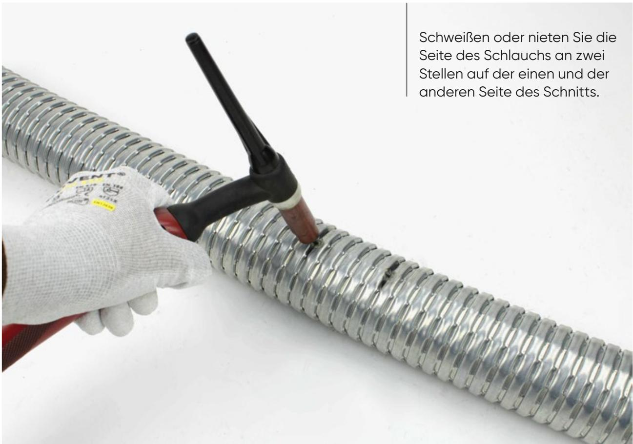
Schweißen oder nieten Sie die Seite des Schlauchs an zwei Stellen auf der einen und der anderen Seite des Schnitts.
